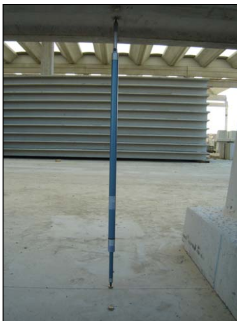
Figura 13: Misura degli abbassamenti
